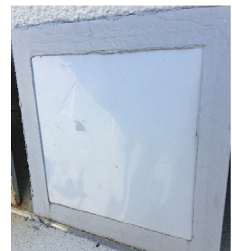
図-5 DLC 全被覆の状況 （浮きのような変状の発生）
